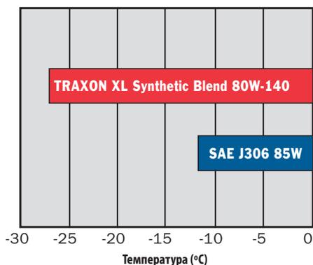
TRAXON XL Synthetic Blend 80W-140 обеспечивает более эффективную защиту в условиях холодных температур по сравнению с маслами марки 85W.
