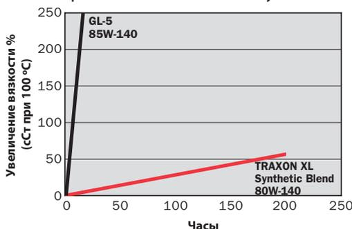
В рамках испытания на окисляемость ДКА эксплуатационные характеристики продукта измеряются тем, насколько кислотность масла (TAN) увеличивается со временем (поэтому чем линия ближе к горизонтали, тем лучше). TRAXON XL Synthetic Blend имеет явное превосходство над трансмиссионными маслами GL-5 марки 85W-140.
